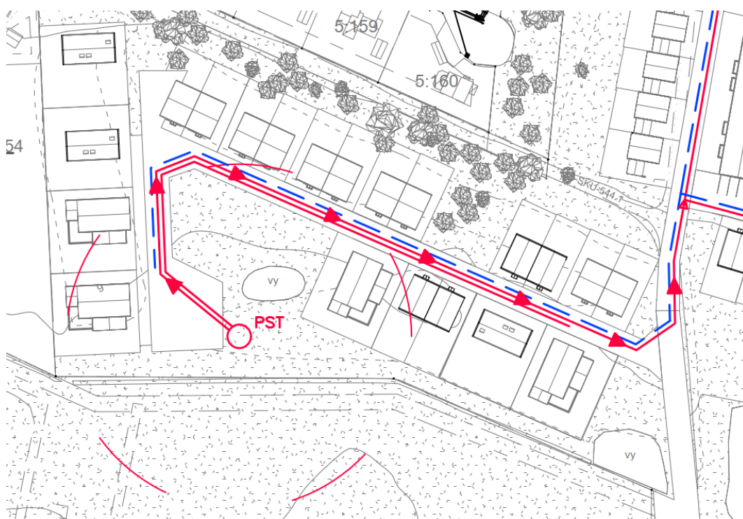
Figur 25. Förslag på VA-hantering inom delområde 1 samt placering av pumpstation. Yttre cirkel visualiserar en 50 meter radie kring pumpstationen för att avgöra om luktreducerande åtgärder behövs.
