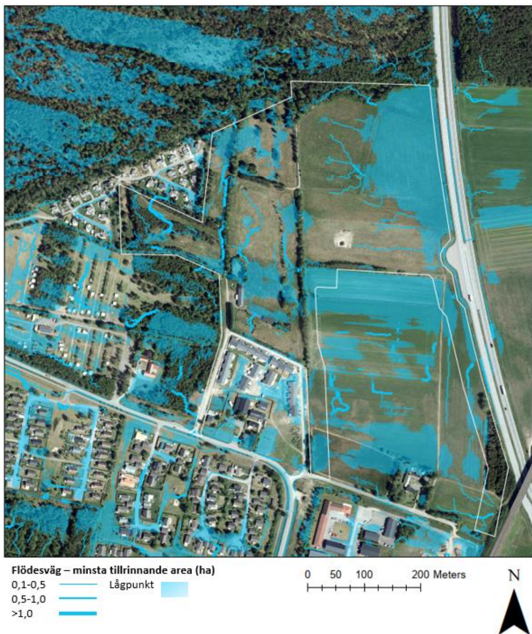
Figur 23. Visualisering av flödesvägar och lågpunkter vid en skyfallshändelse. Ungefärlig planområdesgräns visas med vit linje. Källa: Scalgo Live (2021).
