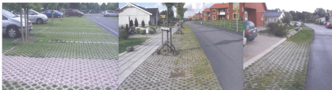
Figur 10. Exempel på genomsläppliga material (Svenskt Vatten, P105)
